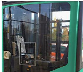
Interphone et ouverture de vitre pour cabine chauffée
