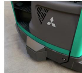
Guidage par induction (capteur)
