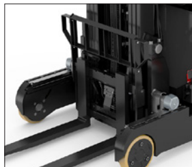
Dosseret d'appui de charge
