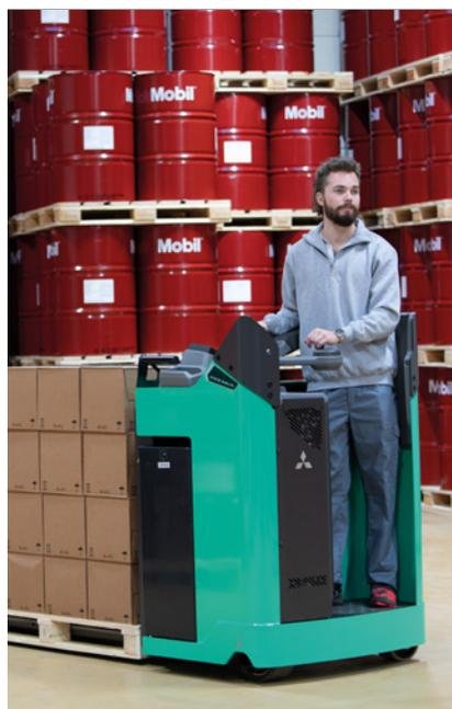
Dans ce transpalette électrique à conducteur porté debout, le cariste dispose d'un espace suffisant, protégé par le châssis. En outre, la machine est compacte et, grâce à son rayon de braquage incroyablement court, elle convient parfaitement aux allées étroites.
