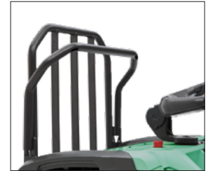
Dosseret d'appui de charge
