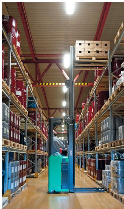
**Concevoir un entrepôt pour un usage avec des gerbeurs à conducteur porté debout plutôt qu'à conducteur accompagnant permet de gagner 35 % d'espace, soit une réduction d'1/3 du coût par palette. En outre, comparé à un chariot à mât rétractable, leur profil compact permet de circuler sur 2 voies dans les allées et d'accroître ainsi la productivité.**
