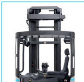
Poste de conduite totalement réglable, avec mini-volant sur accoudoir flottant et plancher à réglage électrique en hauteur de série.
