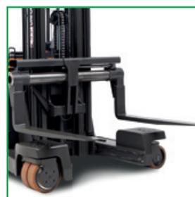
Extraction de batterie à contrôle facile de série. Batterie sur rouleaux acier ou rouleaux motorisés en option, pour un changement de batterie en une minute.
