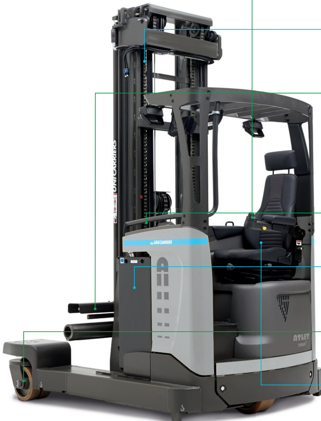
Mât ProVision avec flexibles intégrés et visibilité accrue à travers le toit de protection.
