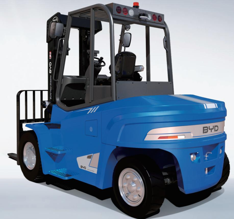
Équipé des batteries Lithium Fer Phosphate 80V/810A ou 1080A les plus puissantes de BYD, le nouveau chariot élévateur à contrepoids Lithium natif BYD ECB60/70/80 a été conçu pour effectuer des tâches lourdes qui étaient auparavant réservées aux chariots à moteur thermique.
